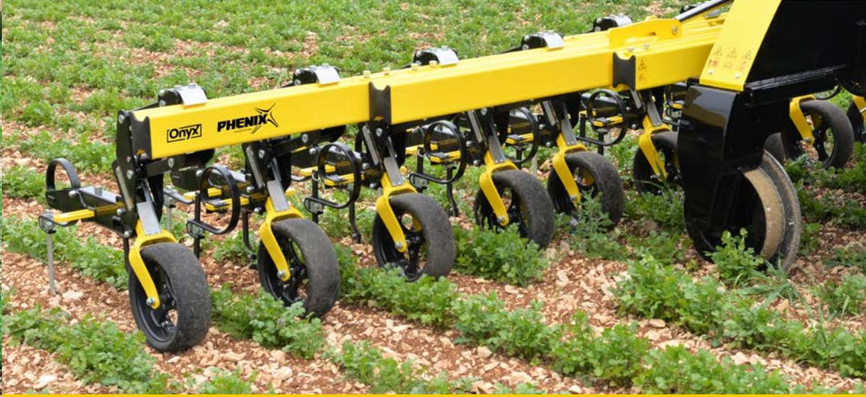
Der Schnittstellenmechanismus mit seiner exklusiven neuen Kinematik schützt die Führungskomponenten vor Verschleiß und Spiel. Der doppelte H-Rahmen bietet maximale Steifigkeit bei gleichzeitiger sicherer Befestigung der Zinkenträger. Die Zinkenträger sind mit konischen Polymer-Bolzenverbindungen bestückt, die für eine beispielhafte Stabilität der Zinken entlang der Reihen und den Schutz der Kulturpflanzen sorgen.
